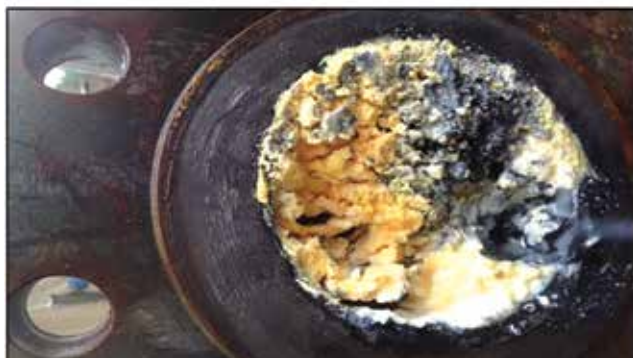
Hình 1. Sự kết tủa các sản phẩm phản ứng của triazine với H_2S .
